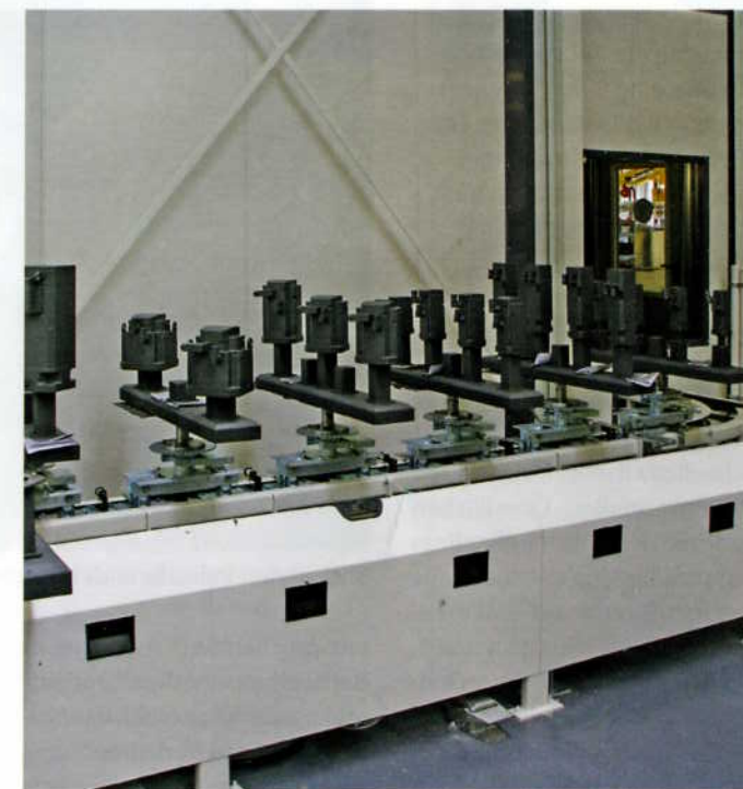
Der Teiletransport wird über P+F-Bodenfördertechnik realisiert.
